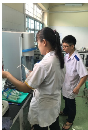
Hình 3. Sinh viên Bộ môn Công nghệ Sinh học đang tiến hành phân tích amoni ( \text{NH}_4^+ ) bằng thiết bị chung cất UDK 149
