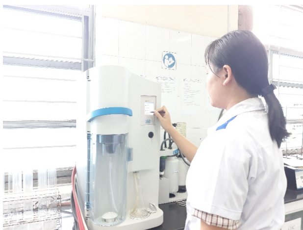
Hình 3. Sinh viên Bộ môn Công nghệ Sinh học đang tiến hành phân tích amoni ( \text{NH}_4^+ ) bằng thiết bị chung cất UDK 149
