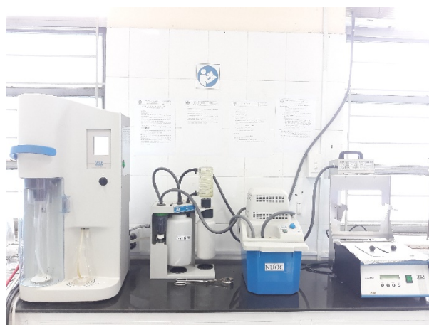
Hình 2. Hệ thống phá mẫu và chung cất đạm Kjeldahl UDK 149 Velp
